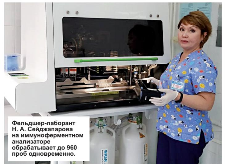
Фельдшер-лаборант Н. А. Сейджапарова на иммуноферментном анализаторе обрабатывает до 960 проб одновременно.
